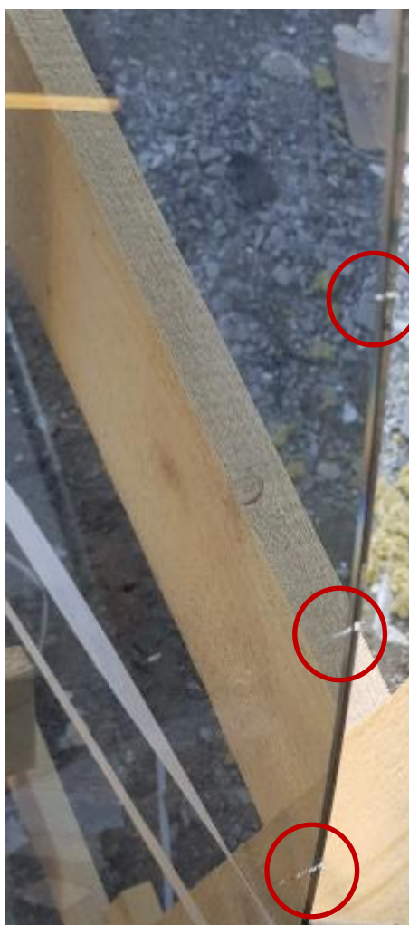
Rysunek 10. Zaprasowania powstałe w procesie gięcia
